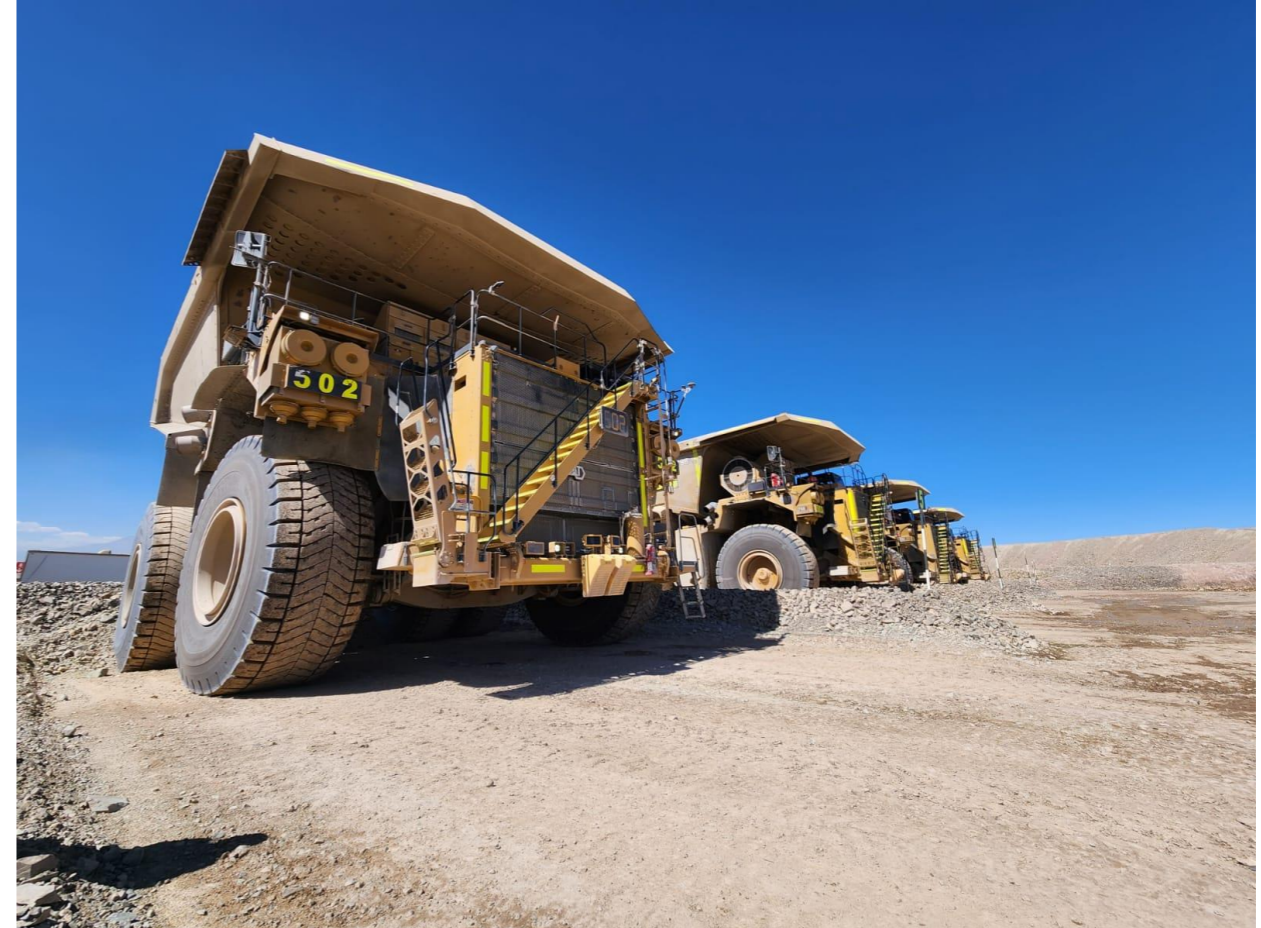
Cat 794 AC - Camión Autónomo
